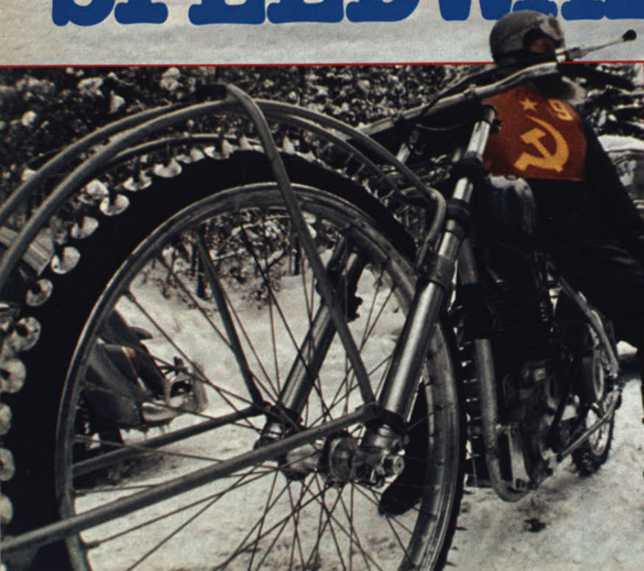
28 Millimeter lang sind die Dornen, mit denen sich die Räder der Speedway-Maschinen ins Eis kralen. Bis zu 150 Spikes sind es hinten, 90 bis 100 vorn
